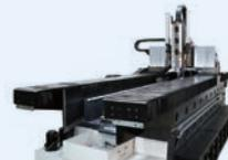
XYZ平台用于激光打标和精密零件组装
